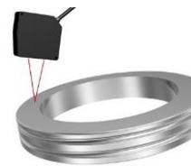
Измерения угла вращения авиационных и автомобильных деталей
