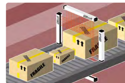
Измерение высоты объектов в движении по конвейеру. Двумерное обнаружение движущихся объектов с использованием 2 комплектов световых завес
